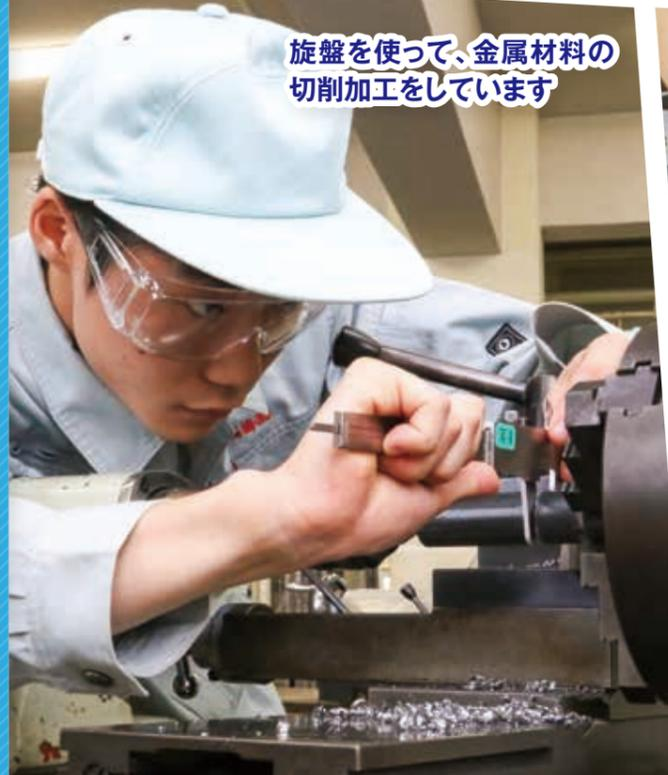
旋盤を使って、金属材料の切削加工をしています
