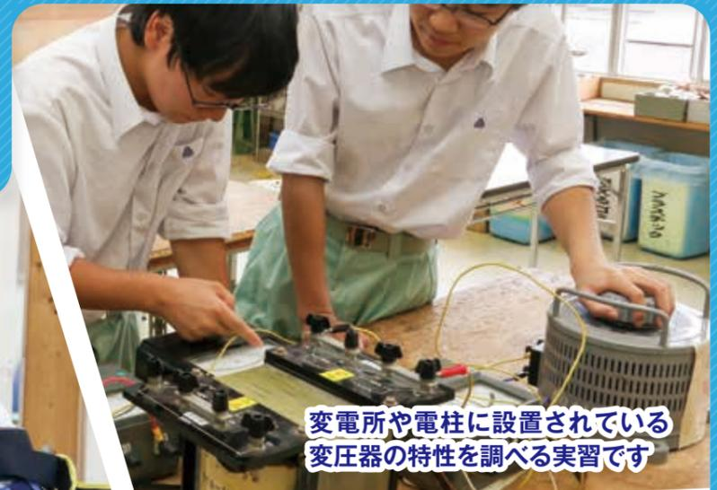
変電所や電柱に設置されている変圧器の特性を調べる実習です
