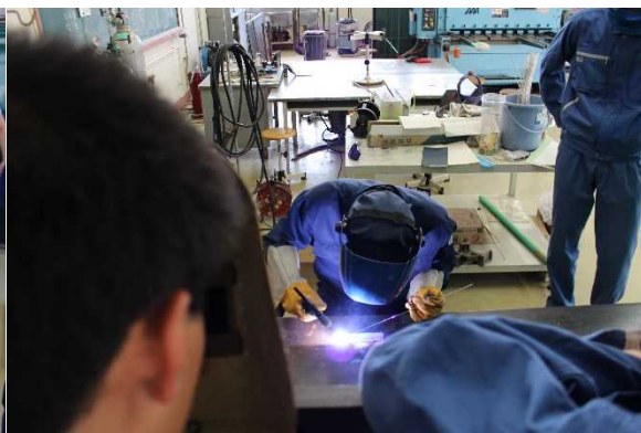
【仮組み後溶接】
