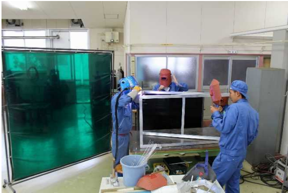
【アルミ溶接作業】
