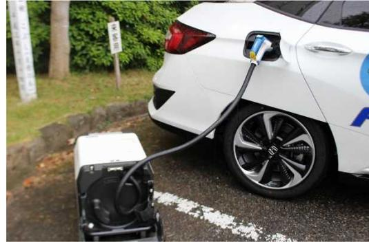
【外部給電ポートと外部給電器の接続】
